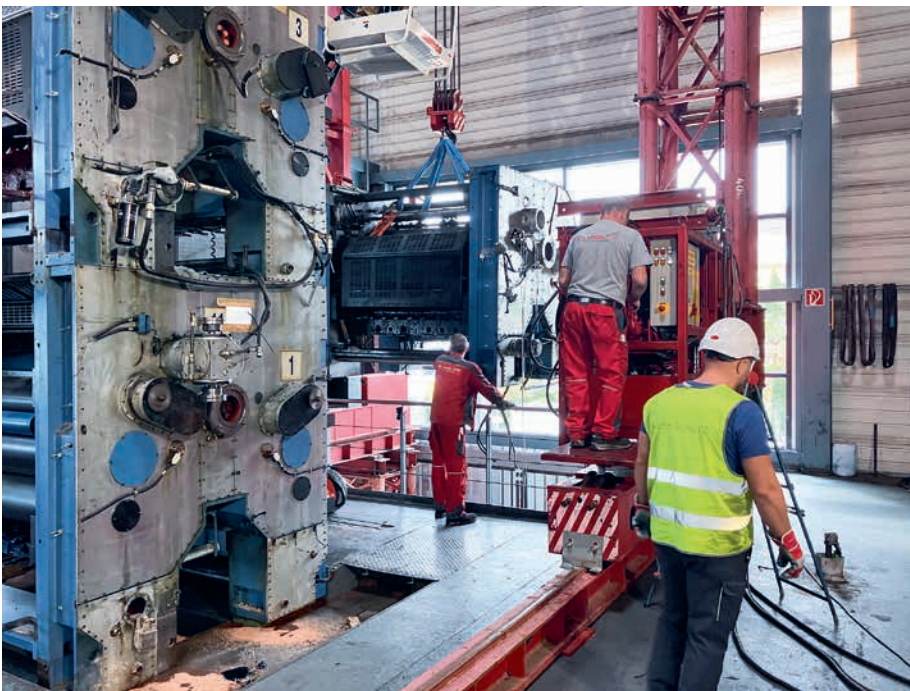
Ein entscheidender Schritt des Umbaus der Druckerei der Mediengruppe Offenbach-Post in der Offenbacher Waldstraße war die Ausbringung von acht Druckwerken zweier Drucktürme.
